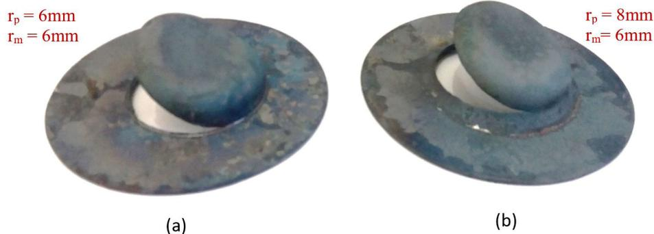
Figura 5. Fratura na zona do canto do punção. (a) Raios da matriz e do punção de 6 mm. (b) Raios da matriz de 6 mm e do punção de 8 mm.
