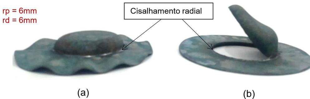
**Figura 7.** Comparação entre as diferentes pressões de atuação no prensa chapas para matriz e punção com raios de 6mm. (a) Pressão 0MPa. (b) Pressão 2 MPa.
