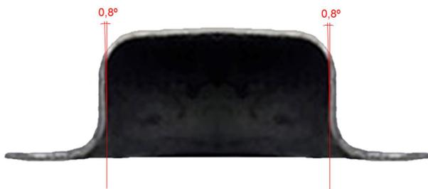
**Figura 14.** Resultado do retorno elástico angular negativo de 0,8°.
